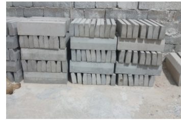
استخدام الخرسانة في تصنيع بردورات الطرق والحدائق
