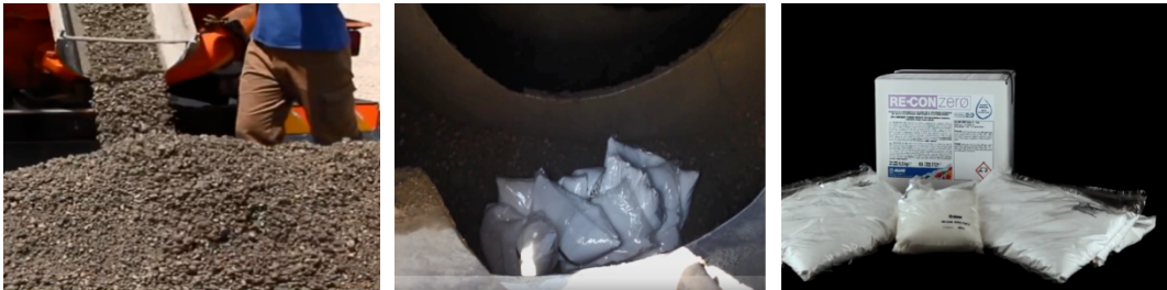
شكل (5) استخدام الإضافات الكيميائية لإنهاء عملية التميؤ لإنتاج ركام خشن
