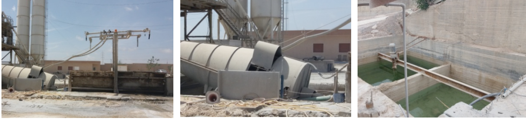
شكل (3) محطة تدوير الخرسانة الطازجة بالطريقة الميكانيكية في احد المصانع
