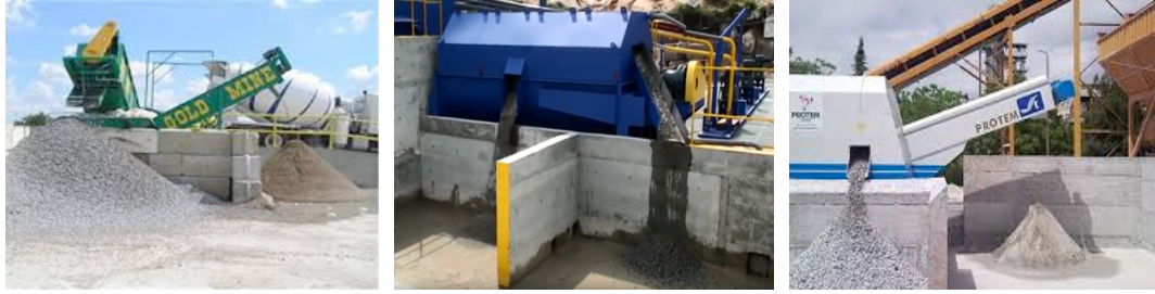
شكل (6) إعادة تدوير الخرسانة في حالتها الطازجة بالطرق الميكانيكية
