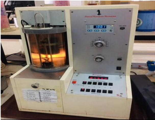
شكل 4. جهاز قياس اللزوجة
