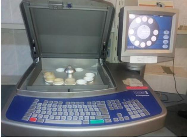
شكل 3. جهاز الأشعة السينية لقياس تركيز المعادن (X-RAYS)
