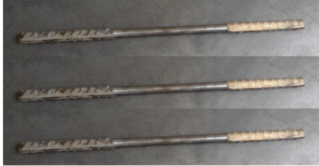
الشكل (2). يوضح عينات حديد التسليح بشكلها القياسي
