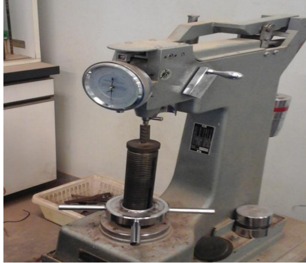
شكل (4). يوضح وضع العينة في جهاز روكويل وتطبيق الحمل عليها
