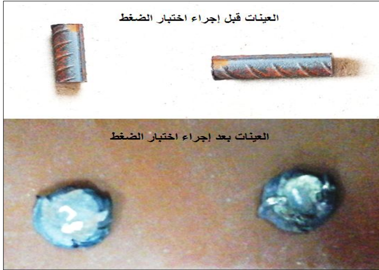
شكل (1). يوضح العينات قبل وبعد إجراء اختبار الضغط
