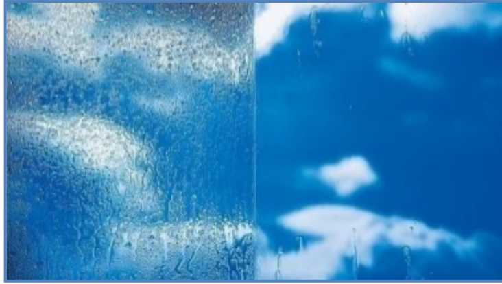
الشكل رقم (4) يوضح الفرق بين زجاج استخدم فيه تقنية النانو وزجاج لم تستخدم فيه تقنية النانو [3]
